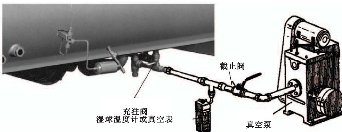
图11 - Yk冷水机组的真空检漏
