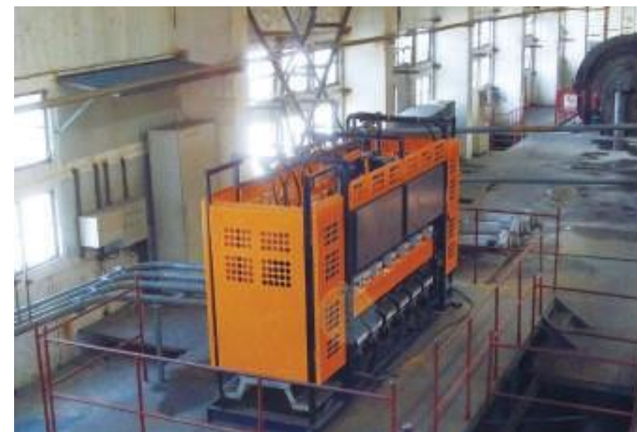
Рис. 6-1 Место применения онлайнового многоэлементного рентгенофлюоресцентного анализатора
