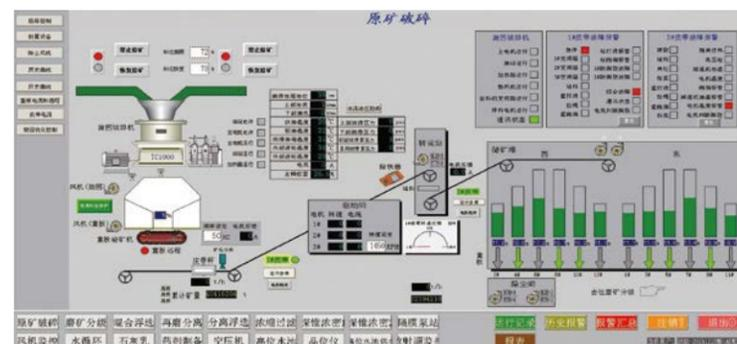
Операция дробления представляет собой первую операцию обогащения, стабильность и нормальность которой непосредственно влияют на последующие работы. Автоматизированная система управления дроблением осуществляет анализ состояния безопасной работы дробилки и сигнализацию на основе контроля температуры и давления масла; АСУ осуществляет управление оптимальным питанием дробилки на основе контроля и анализ нагрузок
