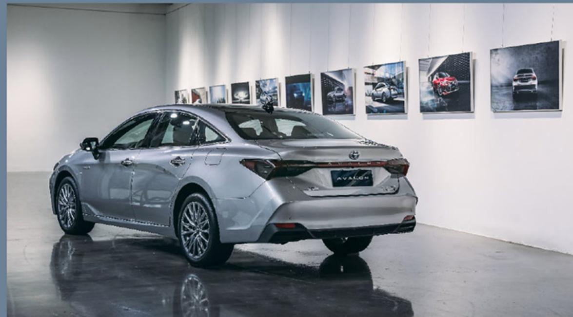
基因传承，过人实力精益求精。在智美升级的同时，全新亚洲龙也承袭了上一代产品的优秀基因。基于TNGA架构打造，全新亚洲龙通过对整车零部件优化，有效降低重心，使车身外形更符合空气动力学，大幅提升抓地力；辅以双叉臂式后悬、AVS自适应可变悬架系统等高阶配备，实现业内顶尖的操控稳定性。另外，全系标配10个SRS安全气囊，始终坚持给用户提供更领先的旗舰级安全。搭载多种丰田全球化动力总成，全新亚洲龙将卓越的燃油经济性和高热效率、高功率输出相结合，实现优异动力性能与超低油耗兼得，动显澎湃恣意，静听自我心声。
